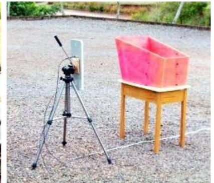
Os objetivos da pesquisa foram estudar a influência que determinados fatores provocam na capacidade de transmissão do sinal de radio frequência entre os vários dispositivos que compõem um sistema RFID, mais concretamente a forma como a proximidade de determinados materiais, normalmente existentes em sistemas de produção, influenciam a transferência de informação entre a etiqueta RFID e o leitor RFID.
