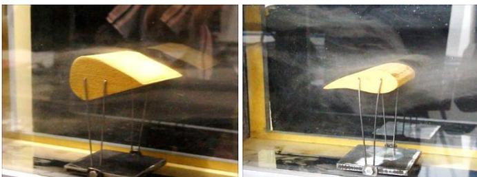
Foram realizados inclusive ensaios aerodinâmicos em túnel de vento, existente no Laboratório de Inovação e Otimização de Produtos e Processos, já anteriormente construído pelos próprios alunos (fotos acima).
